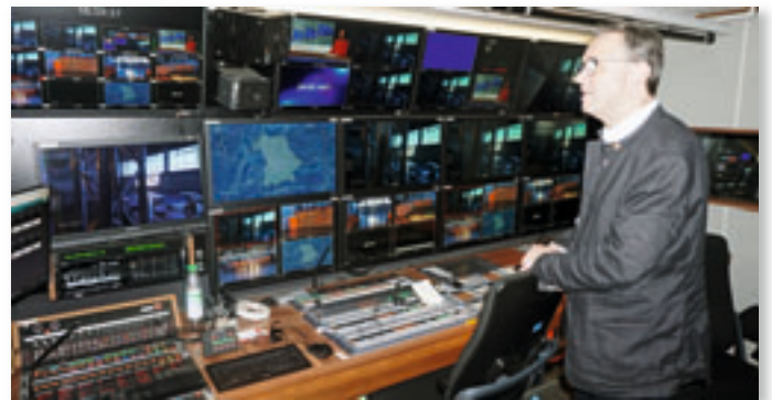
Der Produktionsleiter Thomas Hock vom BR erläuterte Bürgermeister Panten den Ablauf der Livesendung. Ein Truck, vollgestopft mit modernster Sendetechnik, befand sich hinter der Mehrzweckhalle. Dort wurden die Bilder der fünf Aufnahmekameras bearbeitet, das Signal in das Sendezentrum nach München übertragen und in Echtzeit gesendet.
