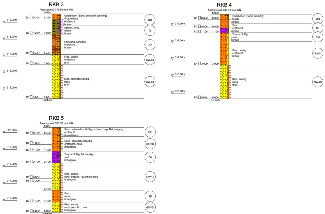
Abbildung 2: Bohrprofile RKB 1-5 aus Baugrundgutachten IFB Eigenschenk vom 28.02.2020
